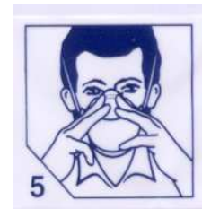
Appliquer la barrette de fixation nasale, lui faire épouser les contours du nez et des pommettes.
