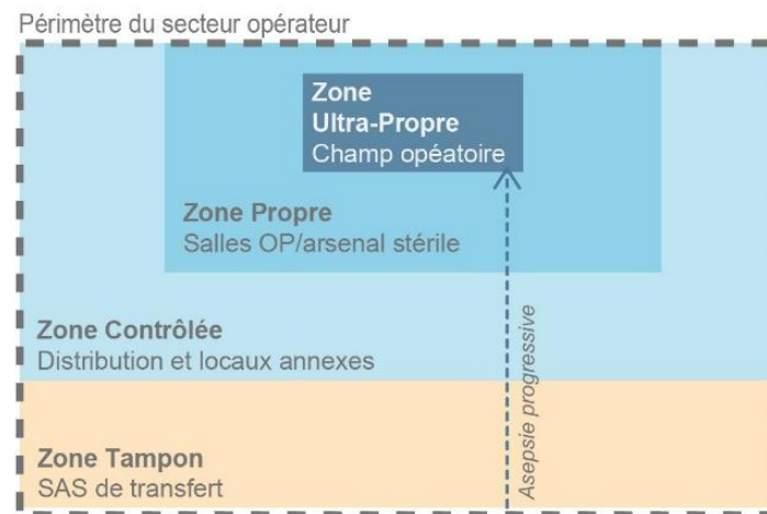
Schéma de principe des quatre zones d'asepsie progressive du bloc opératoire
