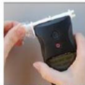
Enlever le film plastique de l'ouverture du soufflage
